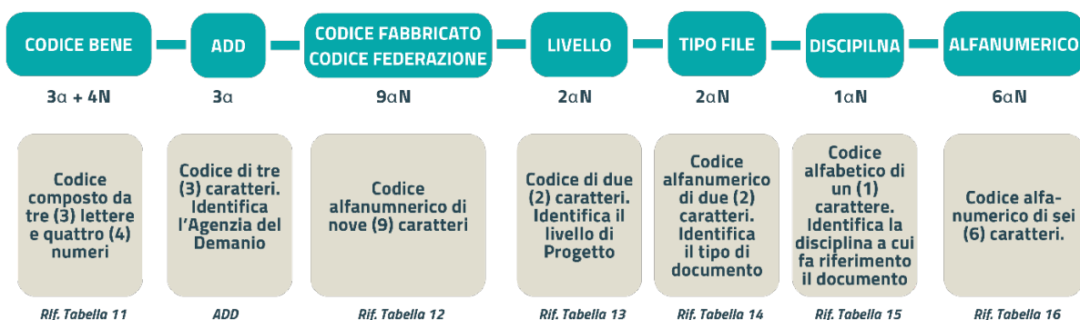
Figura 6 - Schema codifica Modelli ed elaborati
