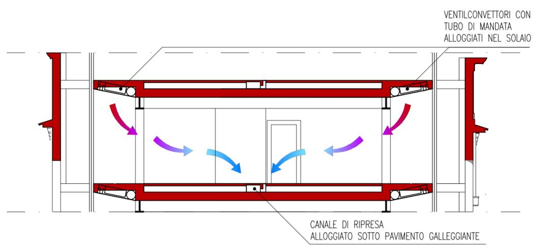
SCHEMA RISCALDAMENTO / RAFFRESCAMENTO, VENTILAZIONE E RICAMBIO ARIA - SCALA 1:100
