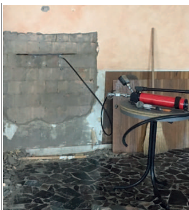
Prova con martinetto piatto singolo
