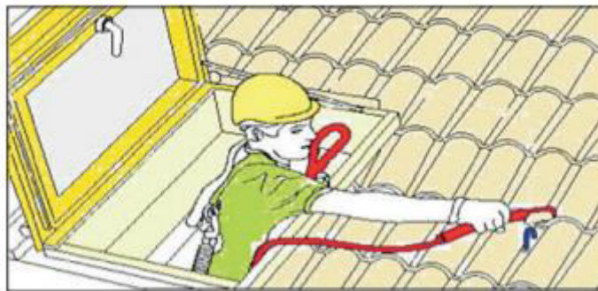
Figura 8 - Esempio di ancoraggio puntuale di accesso.
