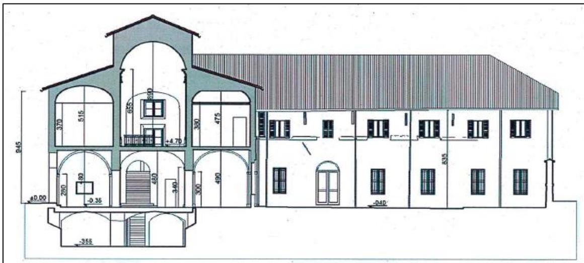
L'ala 2 è composta da due livelli, con il piano terra suddiviso in una parte destinata a portico con pilastri in muratura ed archi. Delle volte a crociera collegano il portico ad un corpo di fabbrica chiuso in struttura mista a laterizio pieno e mattoni semipieni con solai in latero-cemento di recente edificazione destinato ad alloggi
