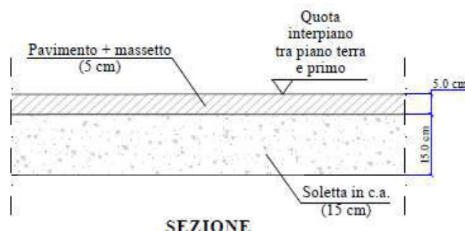
Figura 9 Tipologia di pianerottolo individuato (SR1- Interpiano tra piano terra e piano primo).
