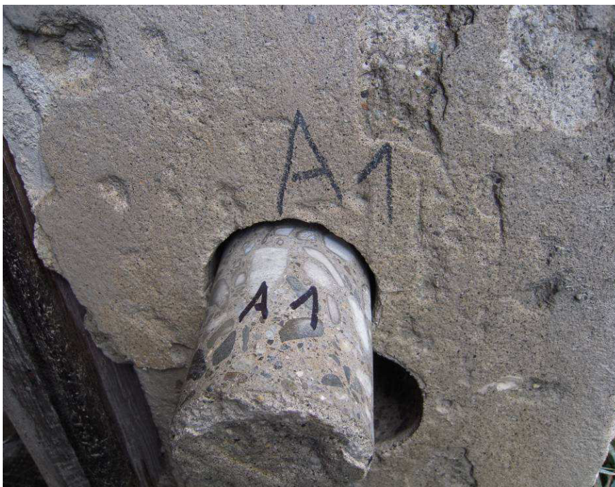
Foto 5 Prelievo carote A1 dal pilastro 1 del Blocco A: sui provini di cls sono state eseguite prove di laboratorio (C1 e C8).
