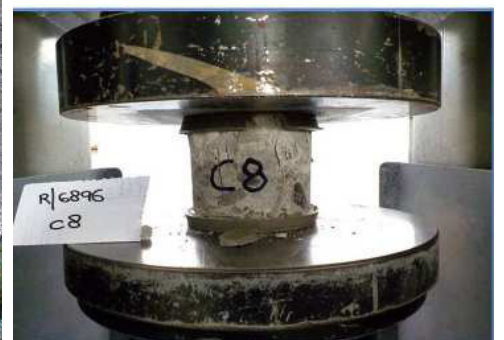
Foto 5 Prelievo carote A1 dal pilastro 1 del Blocco A: sui provini di cls sono state eseguite prove di laboratorio (C1 e C8).
