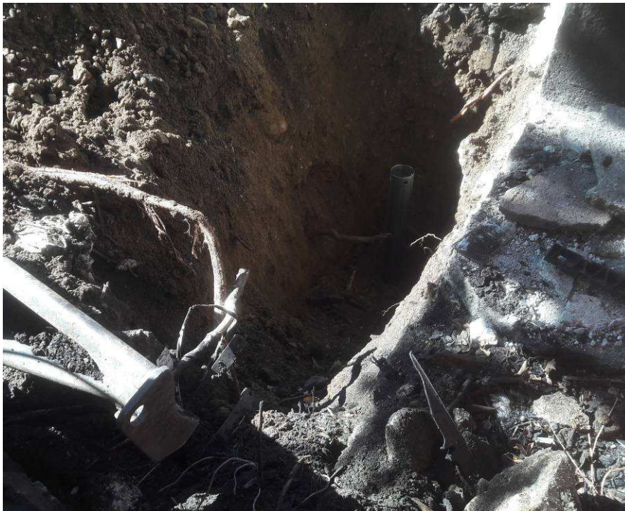
Foto 19 Indagine SF3 (saggio in fondazione) del Blocco C: è stata rilevata una fondazione in cls di altezza pari a 80 cm.
