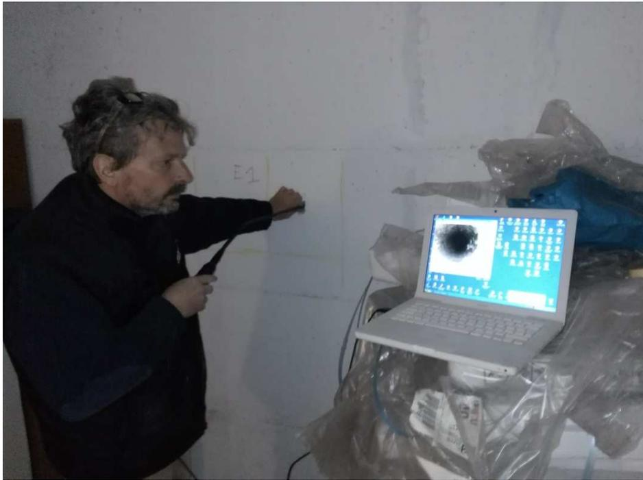
**Foto 03.** *Esempio di prova Endoscopica*
