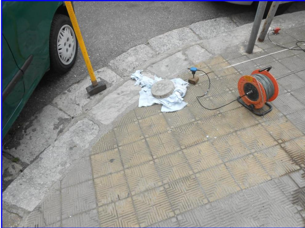
**Fig. 2 – Sorgente energizzante, costituita da massa battente su piastra di alluminio. Come starter/trigger è stato utilizzato un geofono verticale Geospace a 14Hz.**
