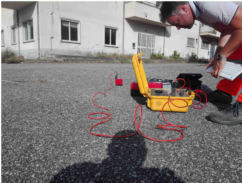
Figura 8 Sensore 3D Geospace 4.5 Hz, sismografo MAE A6000S
