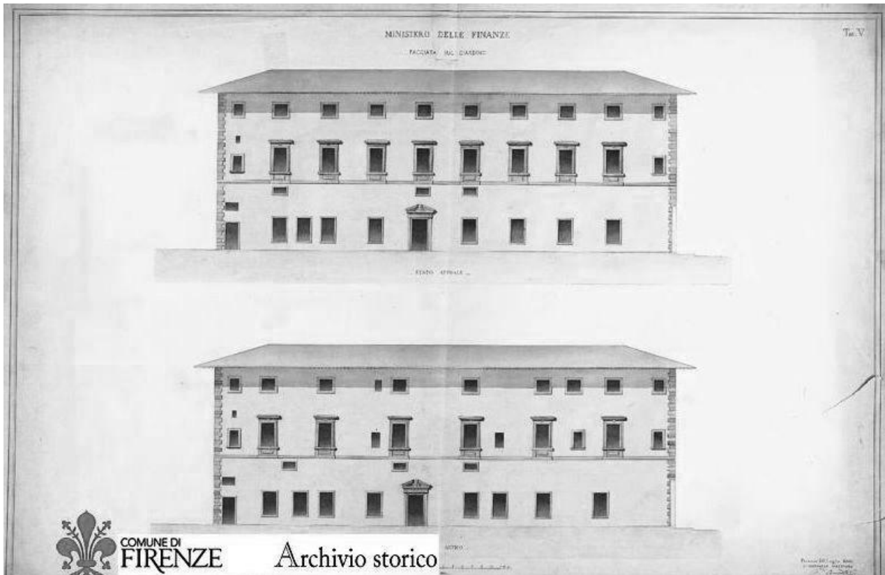
Il fronte verso piazza S. Marco prima e dopo gli interventi di apertura di nuove finestre
