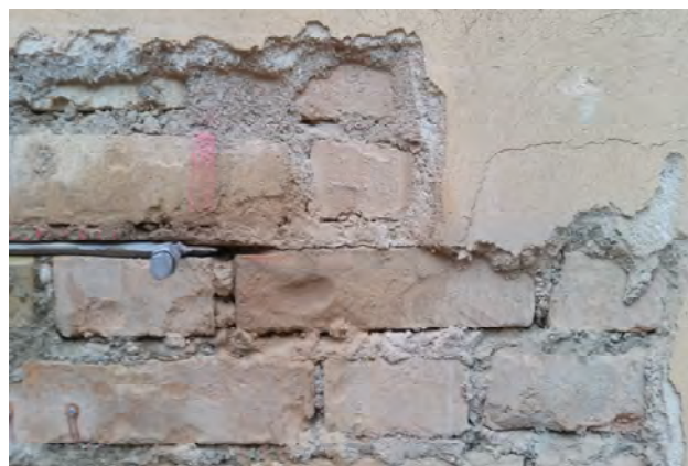
Fig. 3 - Lesione orizzontale registrata alla pressione effettiva di 4500 Kpa.
