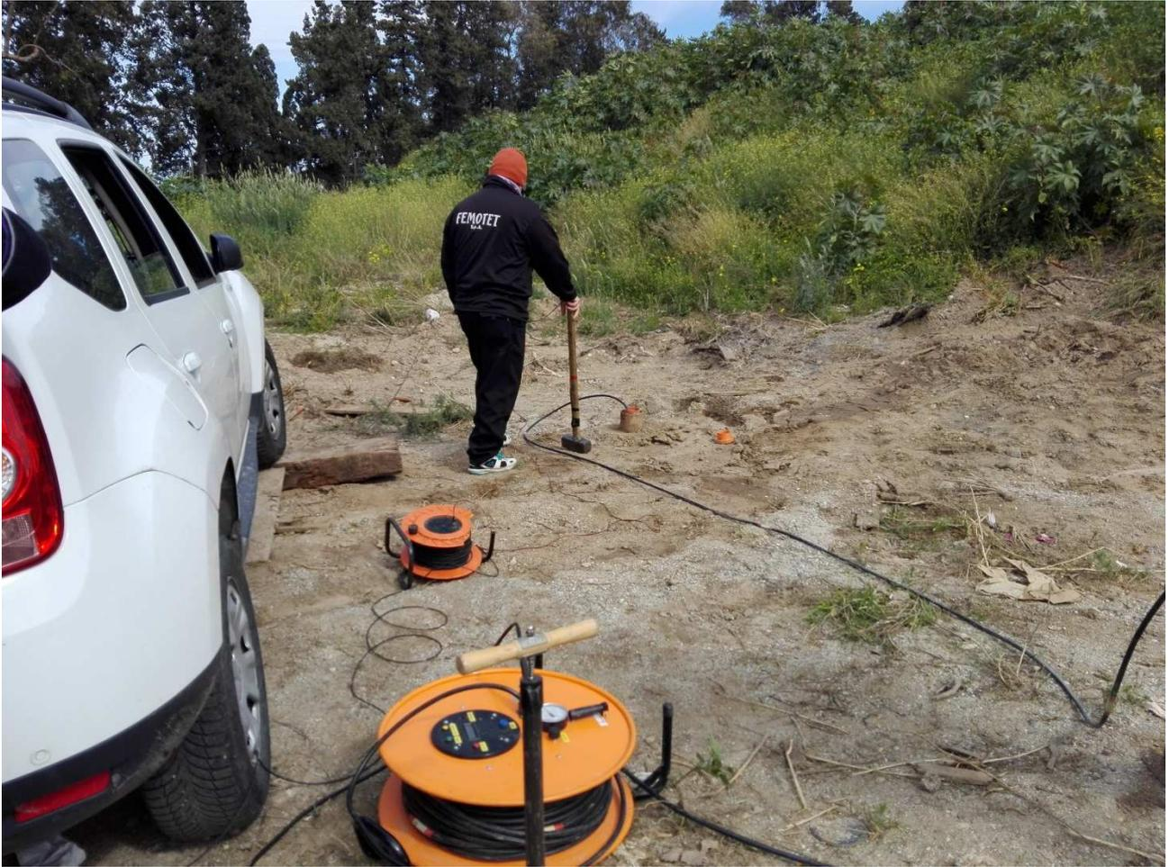
**Foto 1.** Prospezione sismica in foro Down-Hole (DH-S<sub>1</sub>)
