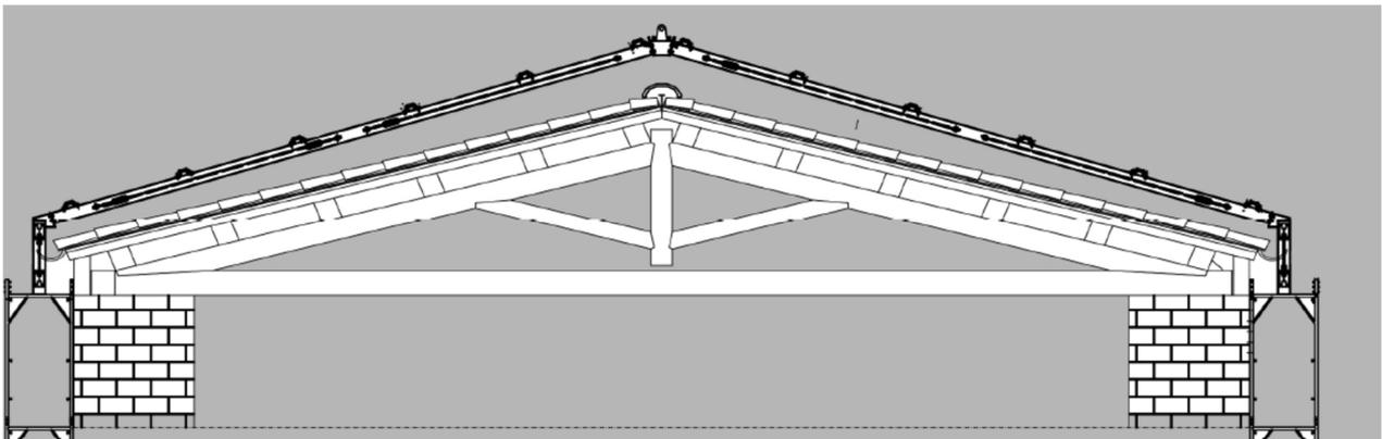
L'elemento modulare che contraddistingue la soluzione prescelta è ascrivibile ad una capriata in carpenteria metallica S275, nella quale la funzione statica viene assolta da una coppia di travi sagomate IPE, con nervature secondarie costituite da elementi tubolari e tiranti di irrigidimento nel piano della copertura in modo da assicurare un comportamento monolitico dell'insieme.
