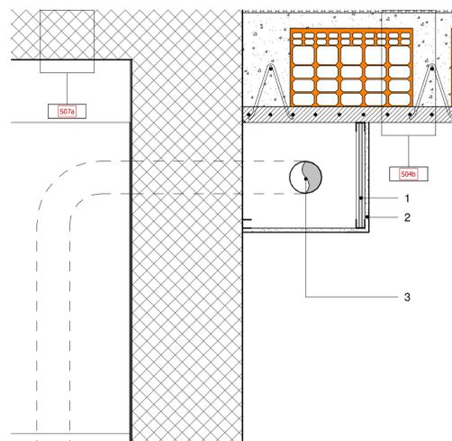
3 DT\_MC\_03 Sezione \_compartimentazione canale aerazione filtro scale
