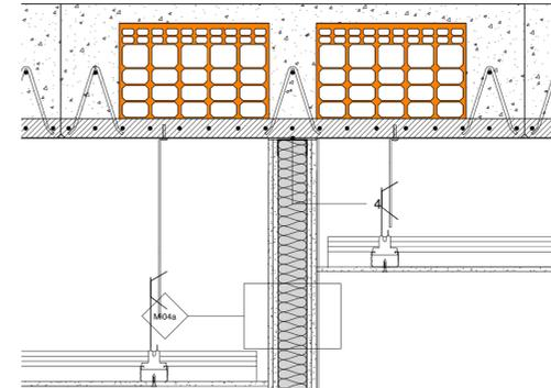
8 DT\_MC\_08 Sezione superiore\_parete cartongesso piano terzo
