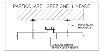
DA INSERIRE UN'ISPEZIONE OGNI 15 M PER TUBI FINO A DN 100 ED OGNI 30 M PER TUBI OLTRE DN 100 SU CONDOTTE LINEARI
