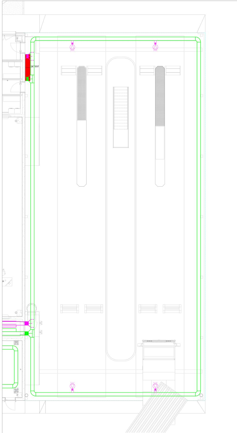
PIANTA PISTE DI TEST - ANTINTRUSIONE E VIDEOSORVEGLIANZA SCALA: 1 : 50
