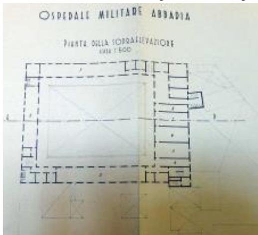
Fig.9 – Planimetria della sopraelevazione con la creazione del secondo piano e del terrazzo anulare (1939)
