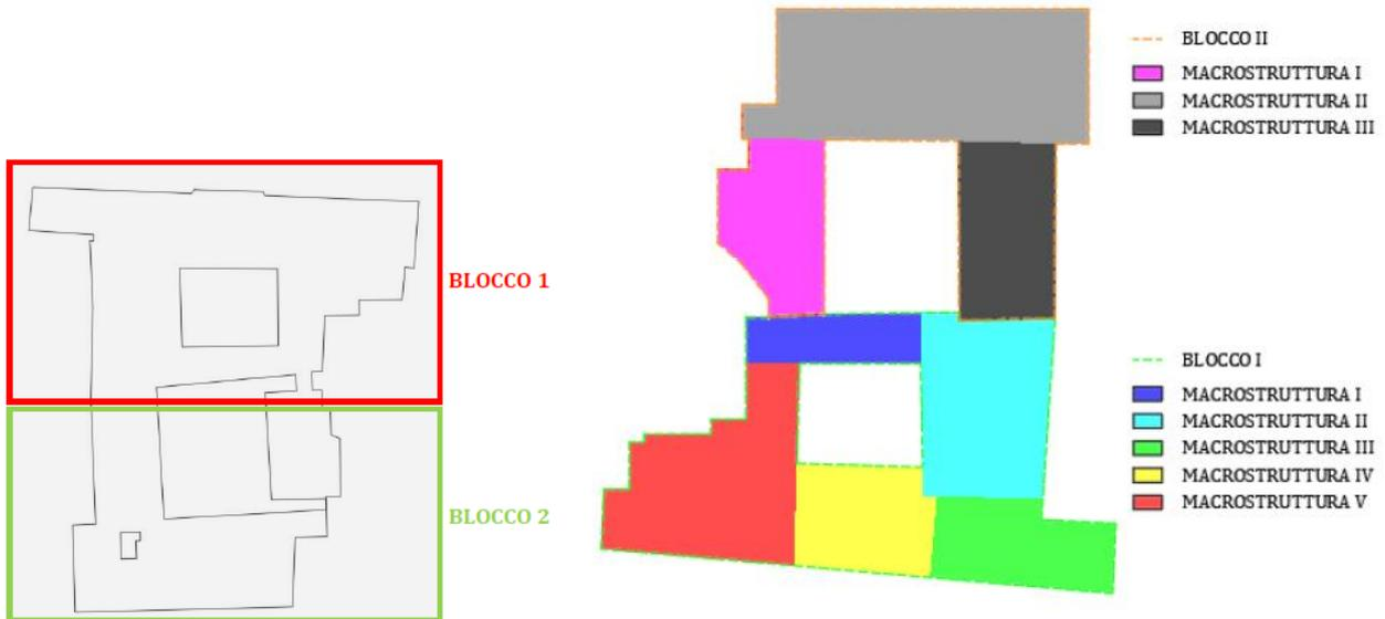
Fig.62 – modellazione con programma PCM- AEDES con suddivisione in blocchi e macrostrutture
