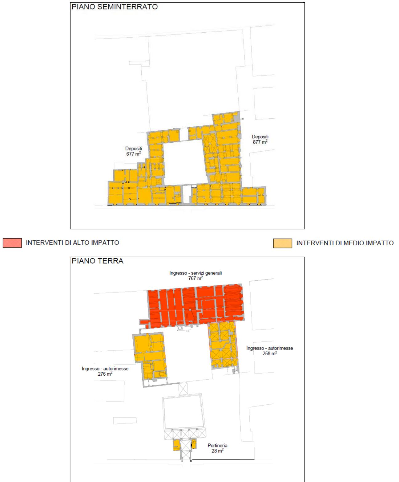
Fig. 101-102 – Schema di previsione degli interventi (piano seminterrato e piano terra)
