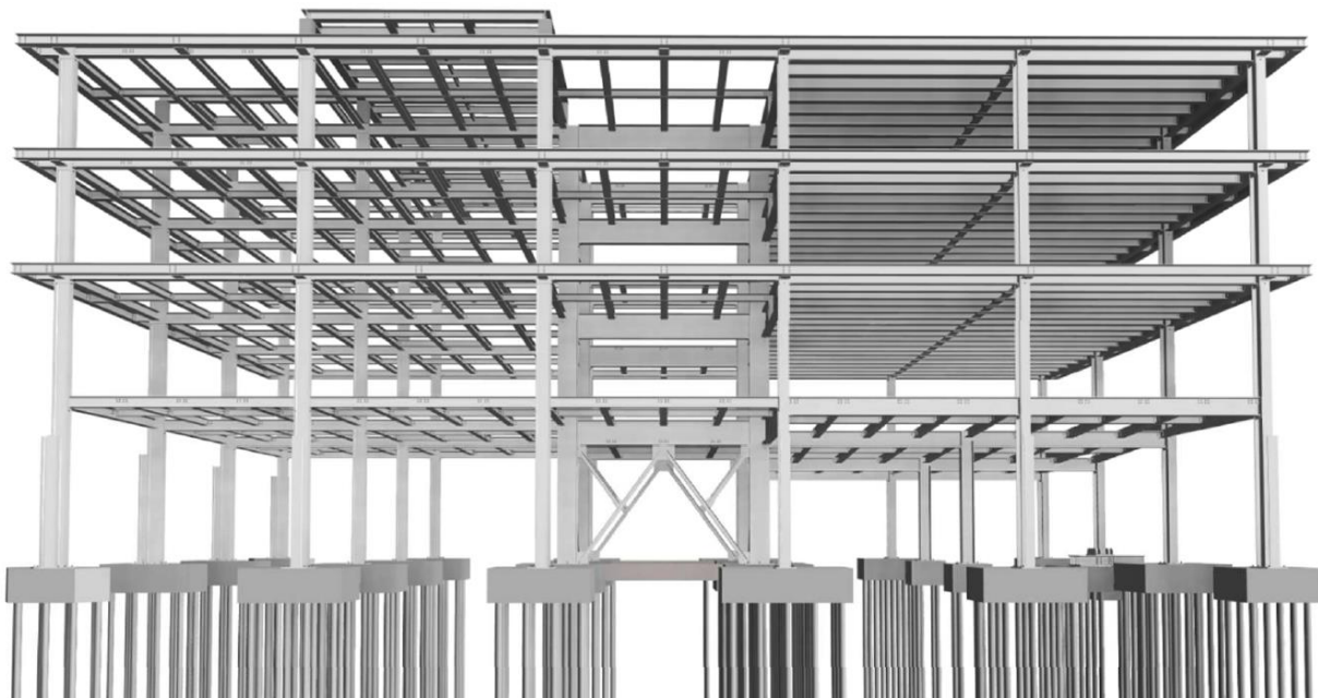
Vista 3D del modello strutturale utilizzato per la valutazione della vulnerabilità sismica
