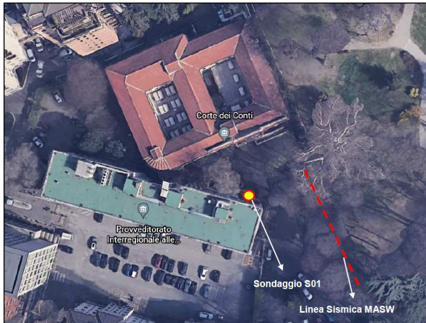
Fig. 18 - Posizionamento dei sondaggi geognostici e geofisici
