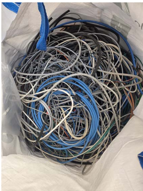
Foto B.1 – Contenuto di un saccone: cavi di segnale e trasmissione dati di piccola sezione, con quota minore di cavi di potenza.
