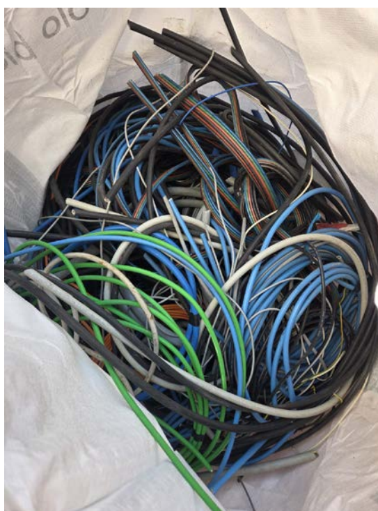
Foto B.3 – Contenuto di un saccone: cavi di potenza unipolari e multipolari di varie sezioni.
