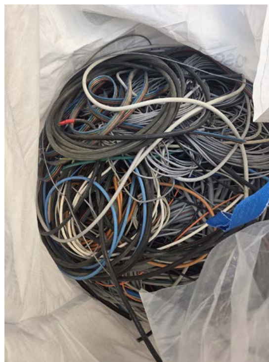
Foto B.2 – Contenuto di un saccone: cavi misti, multipolari di segnale e di potenza con guaina.
