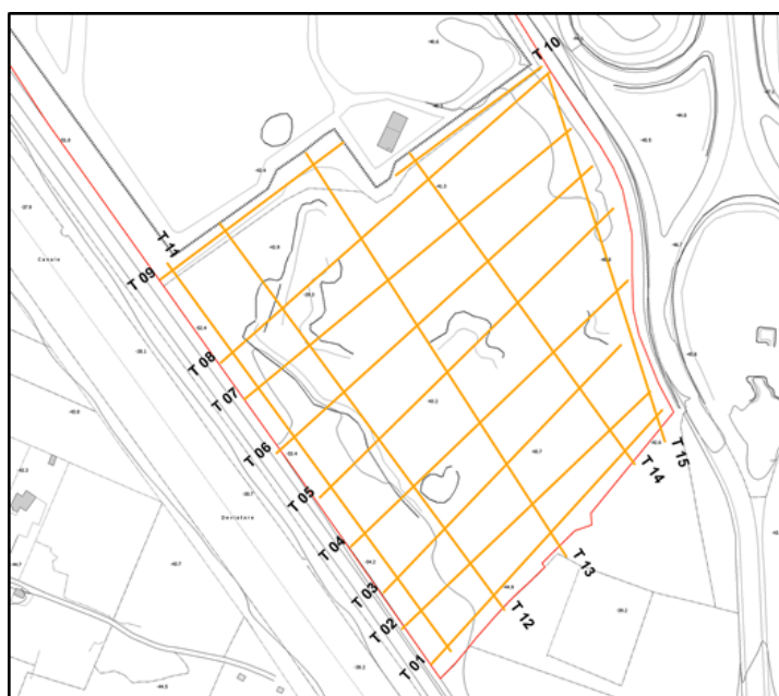
Fig. 19 Ubicazione tomografie elettriche
