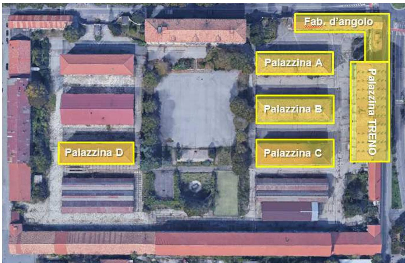
La “Palazzina treno”, posta sul confine est, ospita il refettorio e l'ufficio vettovagliamento. Si tratta di un manufatto a pianta rettangolare, di tre piani fuori terra più seminterrato, realizzato in muratura portante. I solai hanno struttura a volta, mentre il tetto, a due falde e rivestito di tegole marsigliesi, è sorretto da un'orditura lignea. Al piano interrato sono presenti dei magazzini, destinati originariamente al carbone per il riscaldamento. Le finiture sono di vario tipo.
