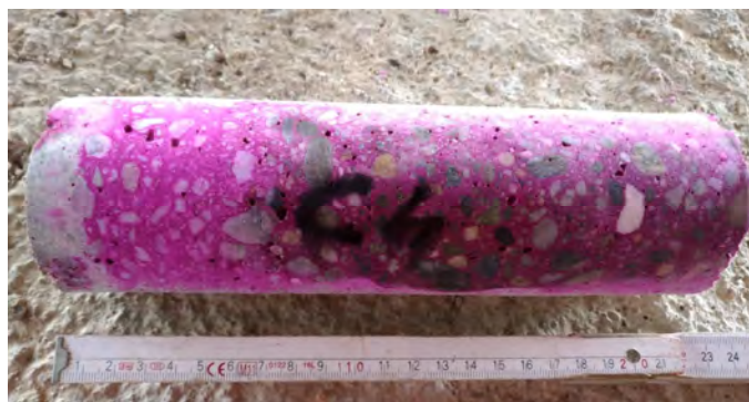
Profondità di carbonatazione
