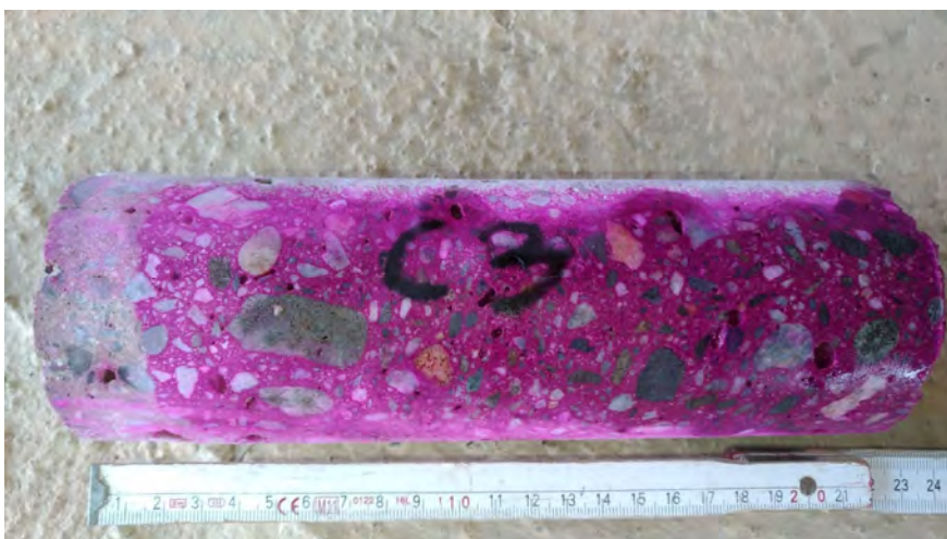
(Tipologia carota con profondità di carbonatazione mm 45)
