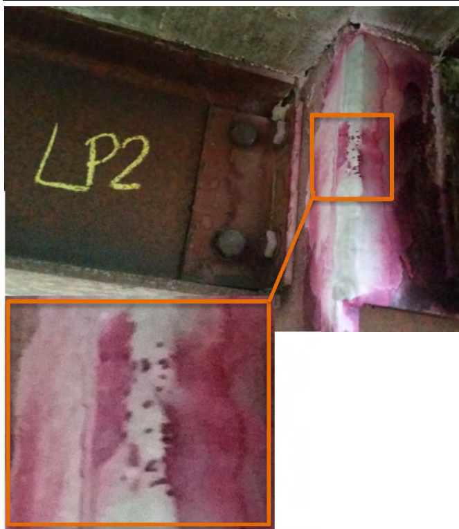
Particolare 1 - Presenza di micropori - Accettabile UNI EN 1289/2006 Livello 2
