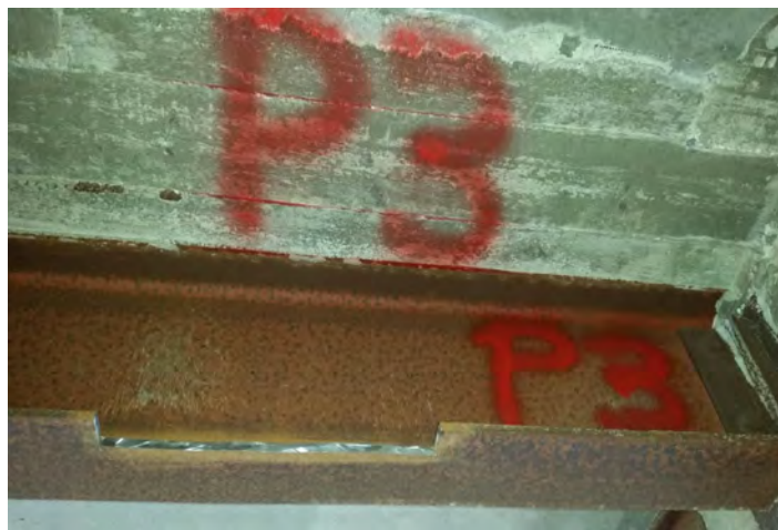
Prelievo del provino metallico
