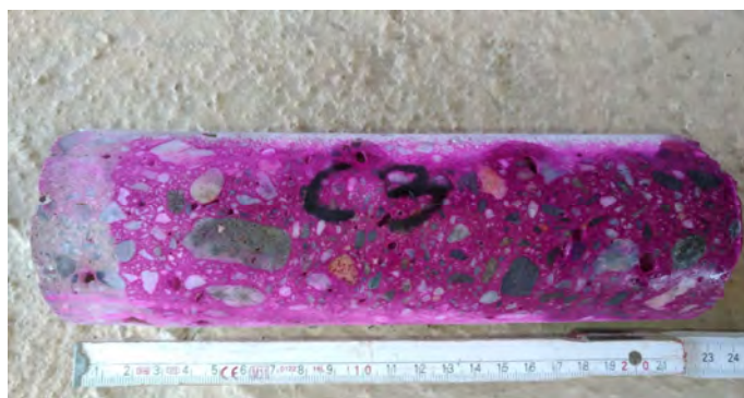
Profondità di carbonatazione
