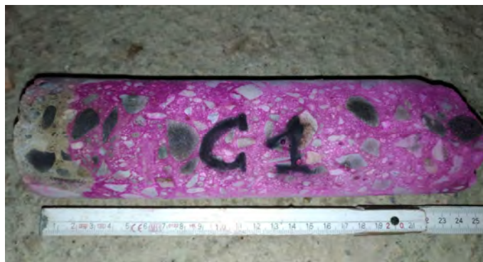
Profondità di carbonatazione
