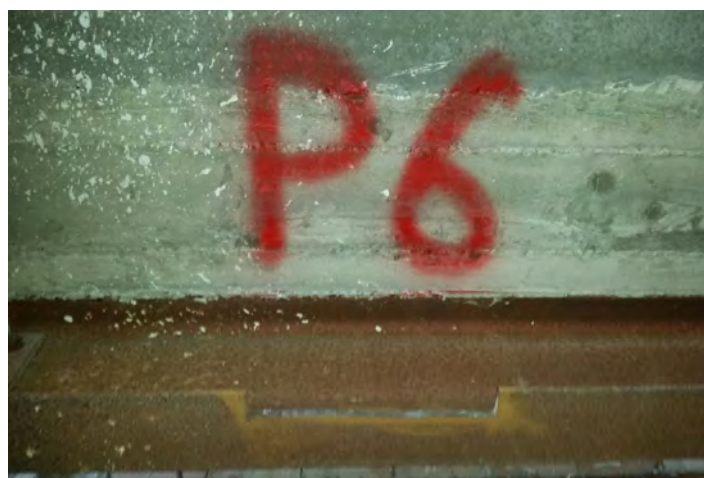
Prelievo del provino metallico
