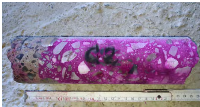
Profondità di carbonatazione
