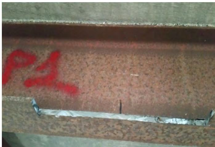
Prelievo del provino metallico
