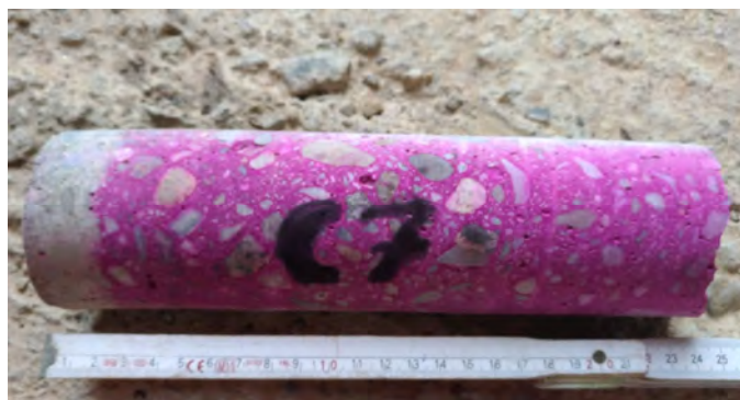
Profondità di carbonatazione
