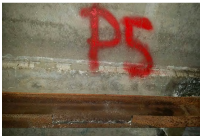
Prelievo del provino metallico
