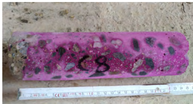
Profondità di carbonatazione
