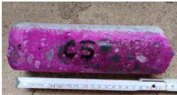
Profondità di carbonatazione
