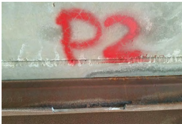
Prelievo del provino metallico
