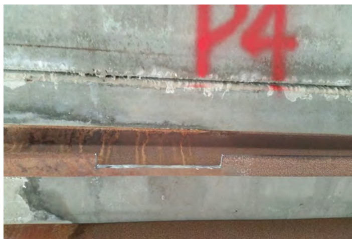
Prelievo del provino metallico
