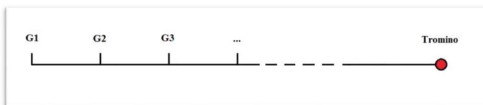
Figura 2: Schema dello stendimento per la registrazione della prova MASW. G1, G2, G3, ... corrispondono alle posizioni nelle quali il geofono starter viene spostato ad ogni energizzazione del terreno. L'interdistanza tra le posizioni del geofono è di 3,0 metri.
