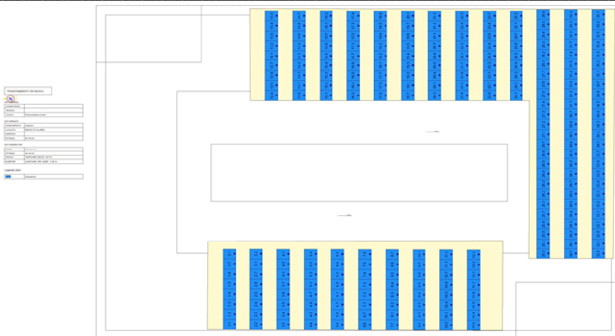
Fig. 4: Posizionamento dei moduli del generatore Generatore1
