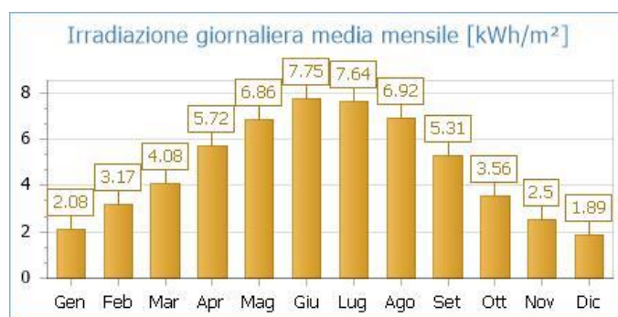
Irradiazione giornaliera media mensile sul piano orizzontale [kWh/m 2 ] - Fonte dei dati: UNI 10349
