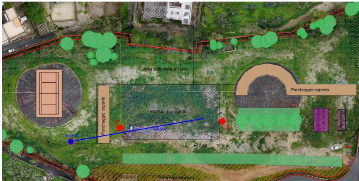
Ubicazione delle indagini DPSH e MASW
