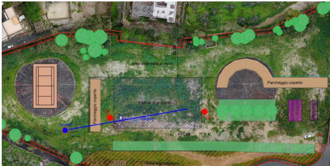
Ubicazione delle indagini DPSH e MASW
