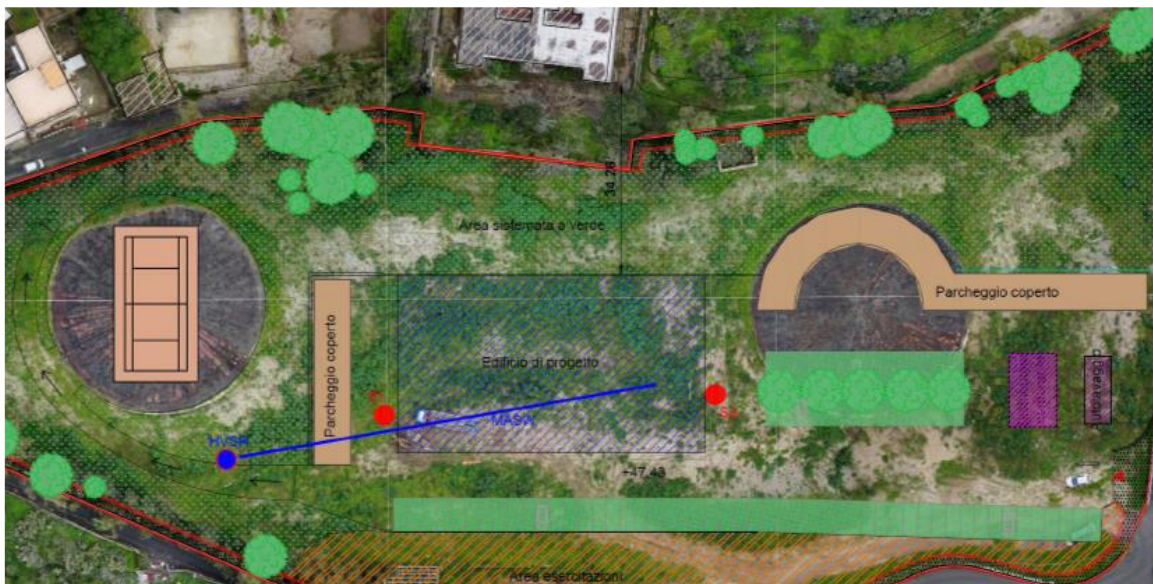
Ubicazione delle indagini DPSH e MASW
