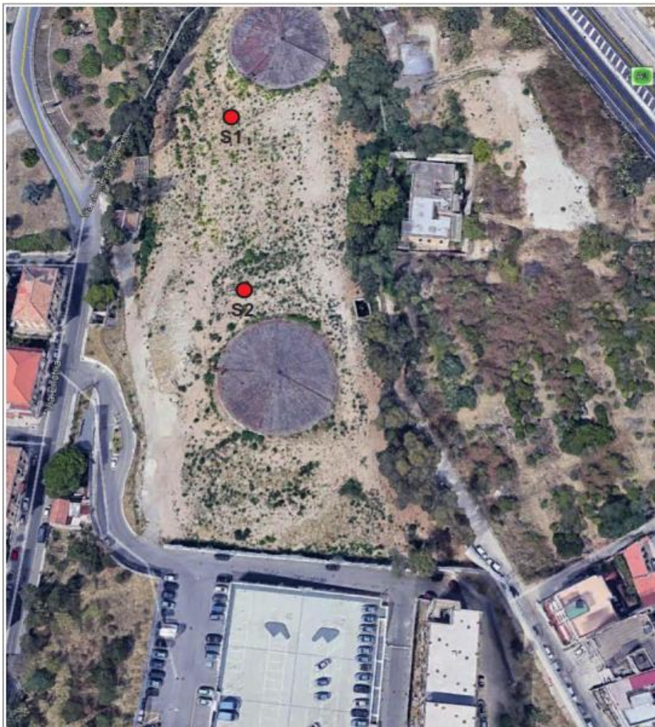
Ubicazione dei sondaggi stratigrafici (S1 , S2)
