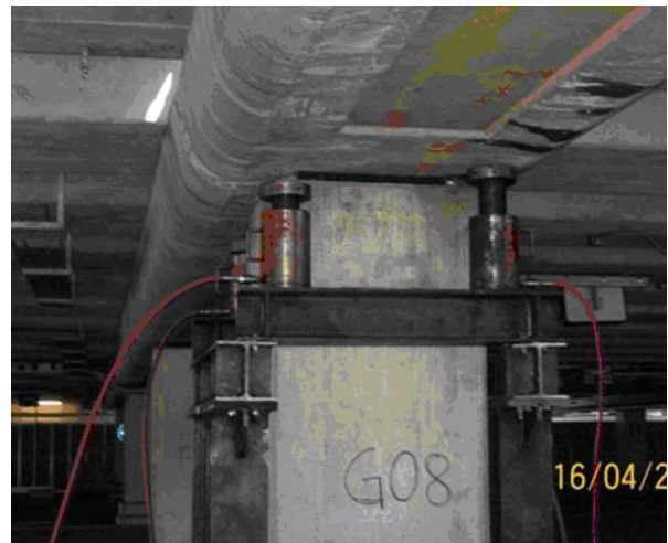
Figura 5 - Particolare del posizionamento dei martinetti
