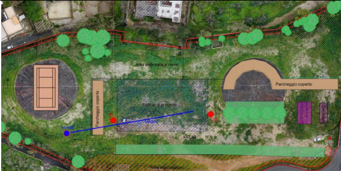
Ubicazione delle indagini DPSH e MASW
