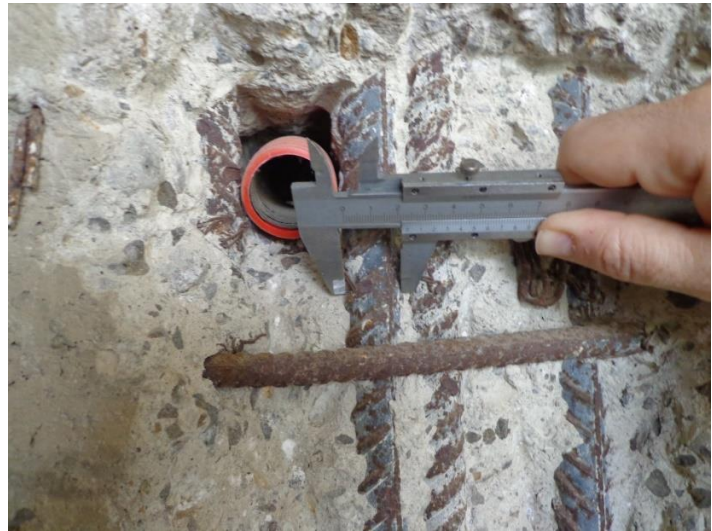
Esempio di prelievo barre d'armatura e controllo dimensioni
