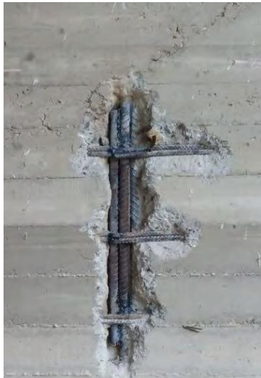
Esempio di prelievo barre d'armatura e controllo dimensioni
