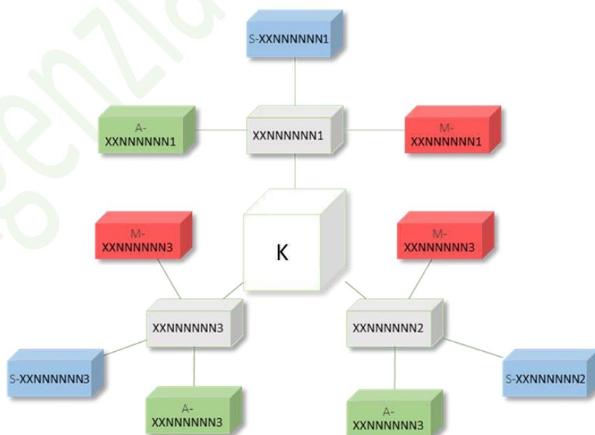
Figura 6 - Esempio Modello federato Complessivo/di Fabbricato (K)
