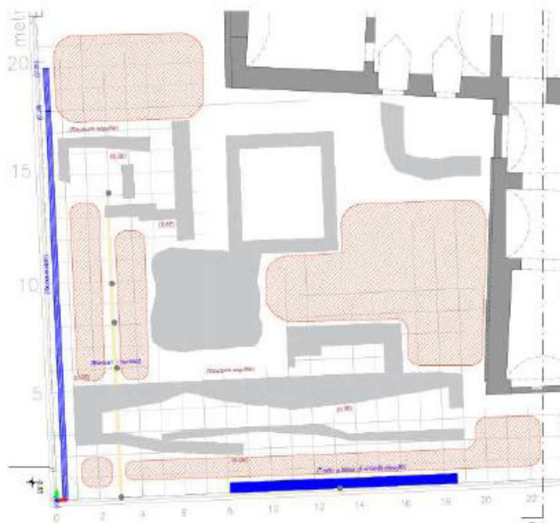
Figura 6 - Planimetria con evidenziate in arancione le aree prive di strutture sepolte
