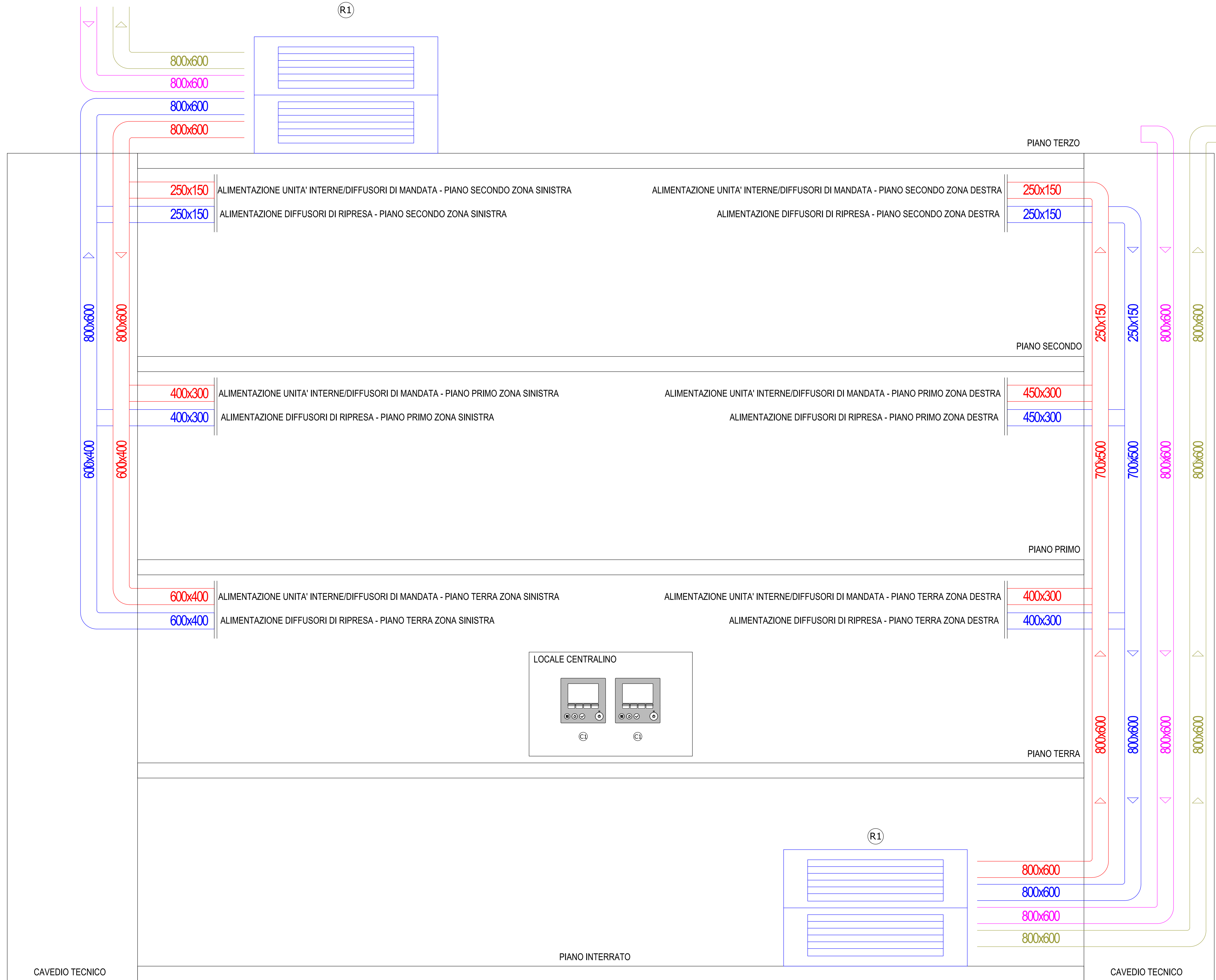
SCHEMA FUNZIONALE IMPIANTO VMC - ZONA UFFICI
