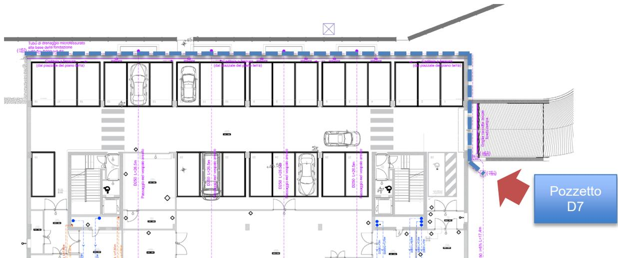
Figura 22: tubo drenaggio microfessurato in PEAD a protezione della fondazione (linea blu tratteggiata)
