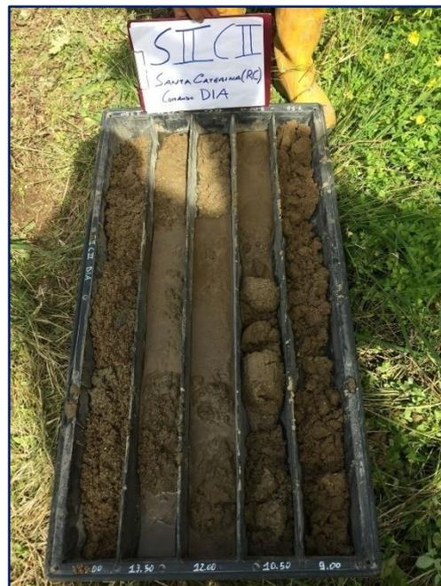
Figura 11: foto dell'ubicazione del sondaggio S2 e cassette catalogatrici fino a -15,0 m.
