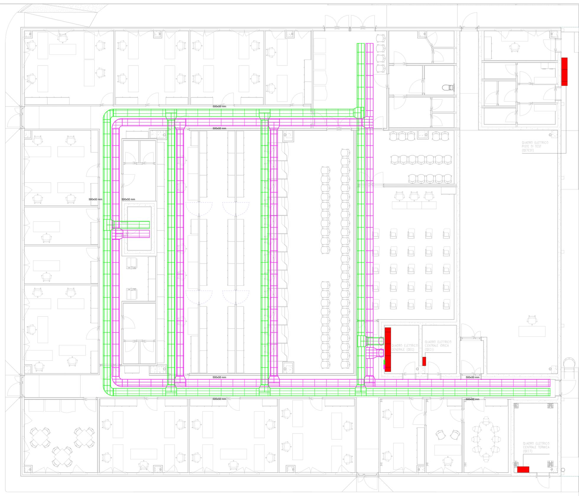
PIANTA UFFICI - CANALIZZAZIONI SOTTO PAVIMENTO SCALA: 1:50
