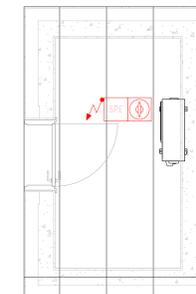
UNITA' ESTERNA IN COPERTURA - ALLACCIAMENTI IMPIANTO TERMOIDRAULICO SCALA: 1 : 50
