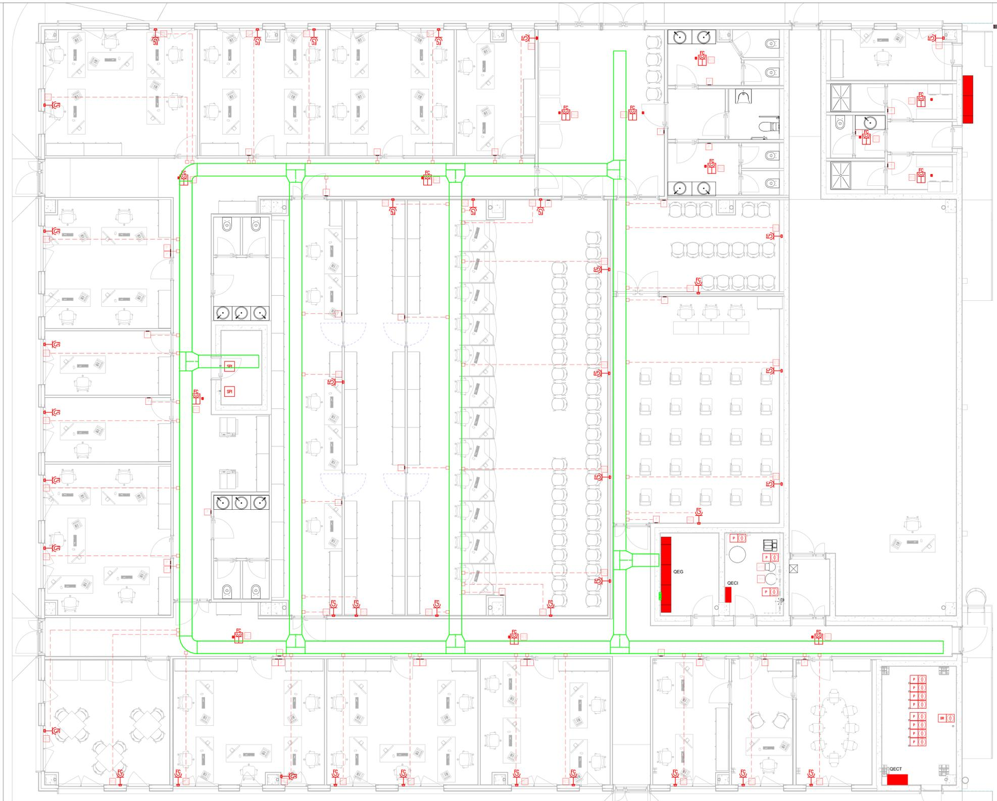
PIANTA UFFICI - ALLACCIAMENTI IMPIANTO TERMOIDRAULICO SCALA: 1 : 50
