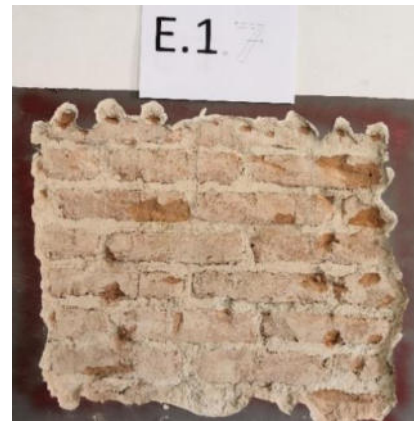
Figura 10 - Muratura in mattoni pieni e malta di calce
