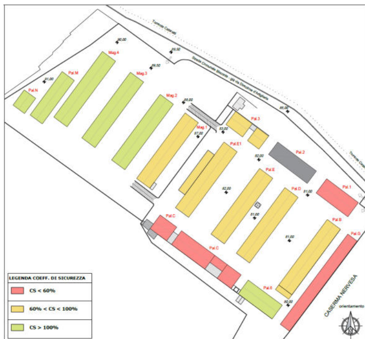
Figura 28 – Coefficiente di sicurezza delle Coperture
