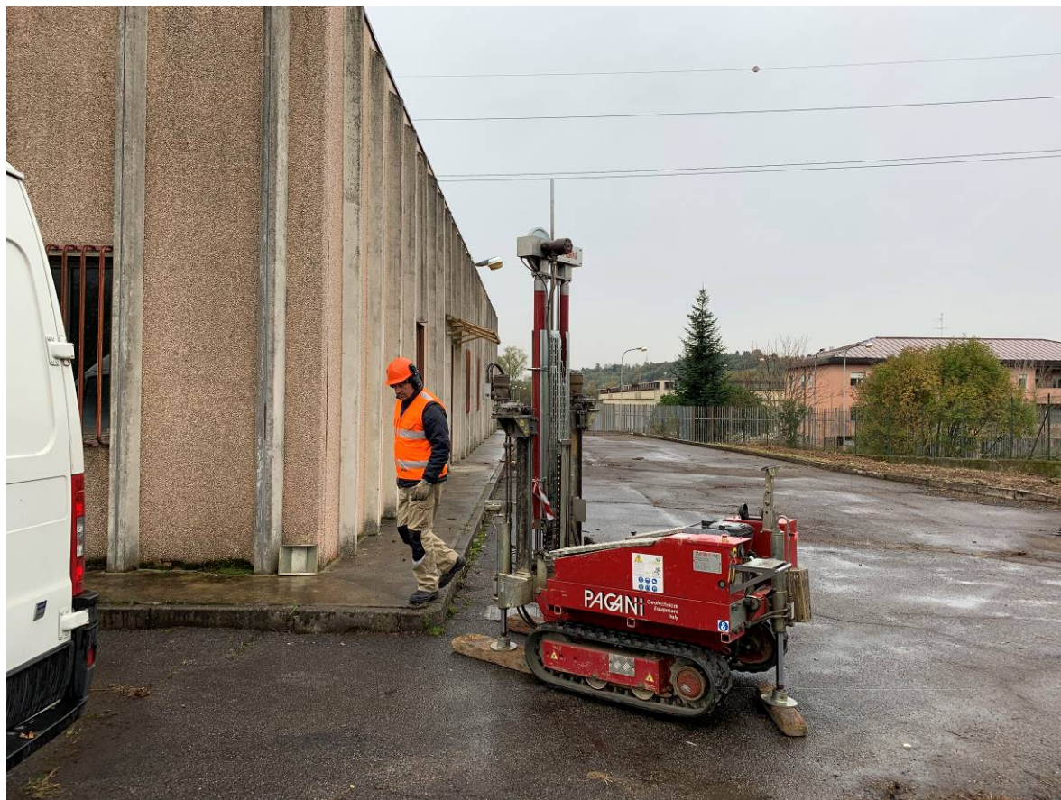
Foto 4 – L'esecuzione della prova penetrometrica DIN 4
