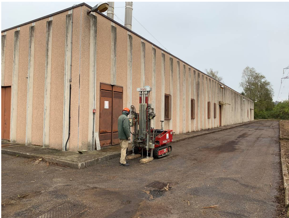
Foto 3 – L'esecuzione della prova penetrometrica DIN 3
