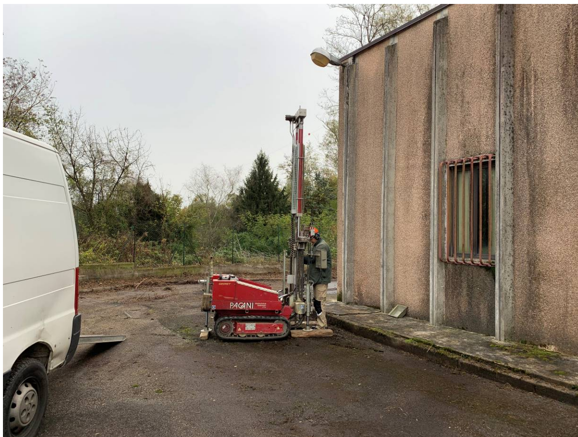
Foto 1 – L'esecuzione della prova penetrometrica DIN 1
