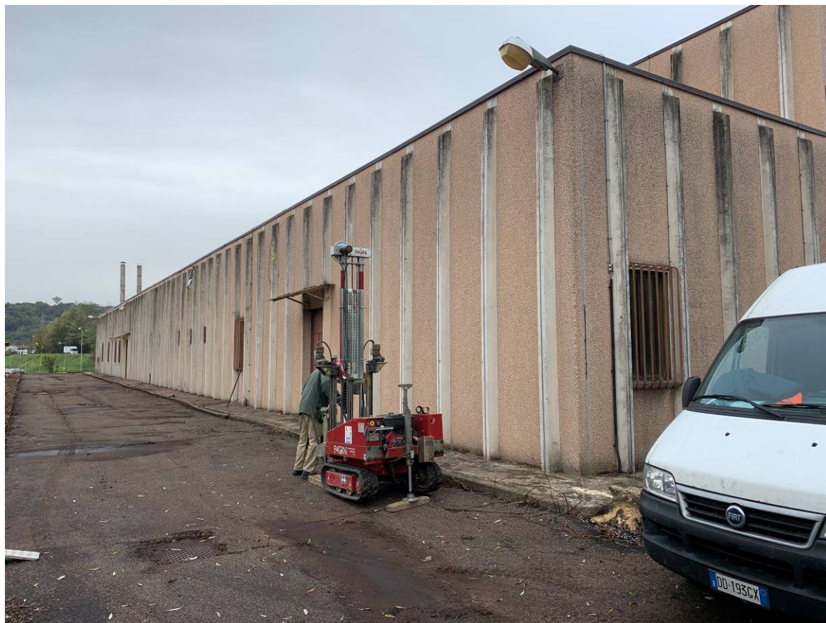
Foto 2 – L'esecuzione della prova penetrometrica DIN 2
