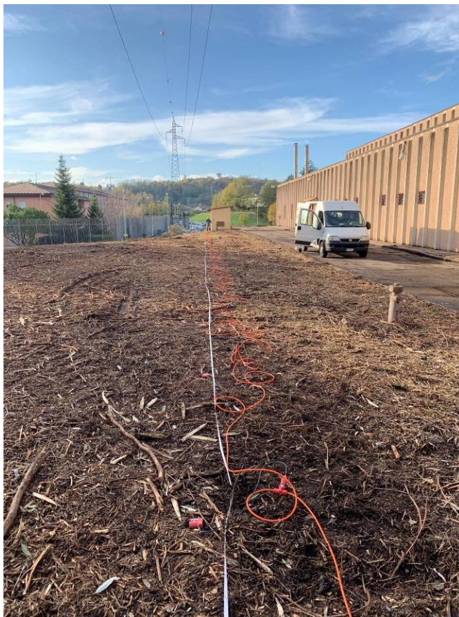
Foto 7 – Lo stendimento della prova sismica MASW
