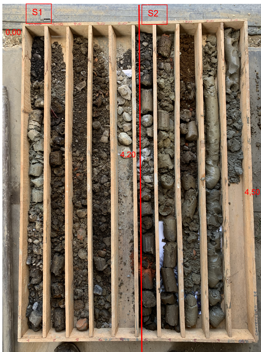
Foto 6 – La cassetta catalogatrice con i campioni estratti dai due sondaggi
