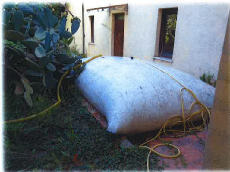
Serbatoio di acculumo per l'esecuzione delle prove di carico
