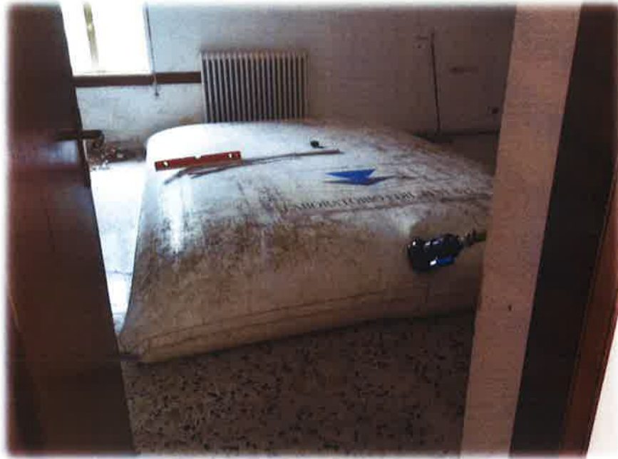
Serbatoio a carico massimo durante la prova n. 1
