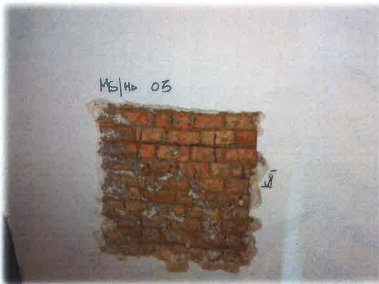
Prova n. 3 – Individuazione dell'area di prova e rimozione dell'intonaco
