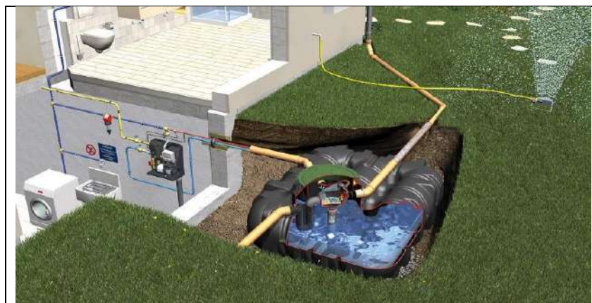
Figura 45 – Schema tipologico recupero acque piovane
