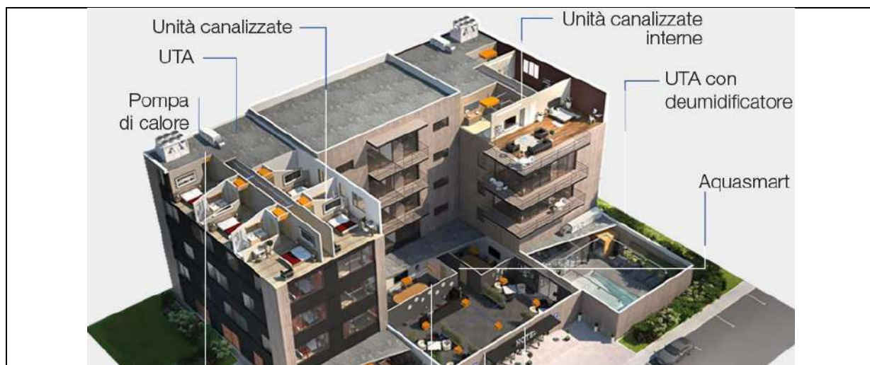
Figura 40 – Sistema tecnologico: impiantistica alloggi
