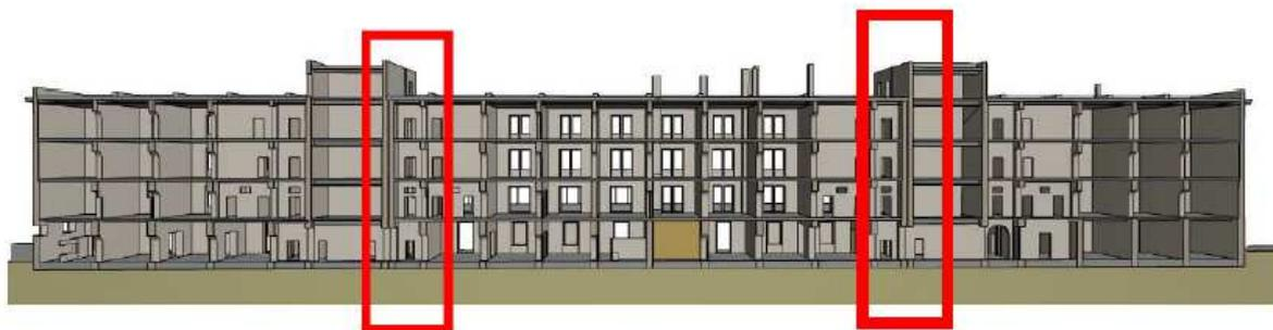
Figura 18 - Ubicazione giunti strutturali
