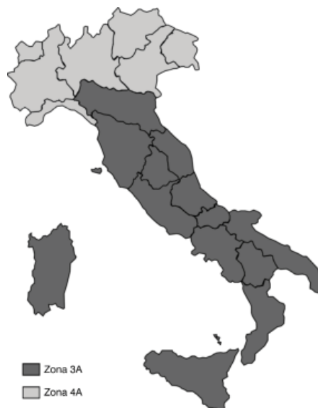
Figura 1. Divisione in zone climatiche ASHRAE per l’Italia secondo le proposte previste da GBC Italia.
