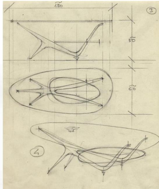
**18. Tavolo con struttura in compensato di acero naturale curvato e lucidato, giunti di ottone spazzolato e piano in cristallo temperato, ideato per la mostra "Italy at work" a New York, 1950**
