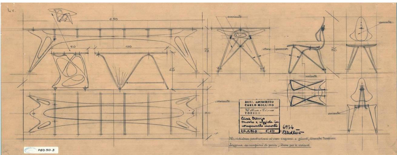
**19. Sedia in compensato curvato con struttura metallica continua, ideata per la Mostra "Italy at work" (New York), 1950**
